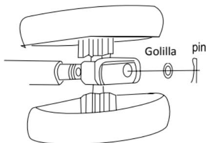
Inserte las ruedas delanteras en el eje delantero y asegure primero colocando la golilla de metal y luego insertando el pin en los orificios que se encuentran en el eje.
