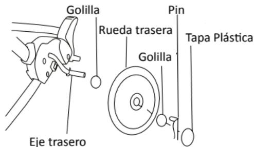
Inserte las ruedas traseras en el eje trasero primero colocando una golilla de metal, luego las ruedas, luego una golilla de metal, para asegurar coloque un pin. Para finalizar introduzca la tapa de plástico hasta que escuche un "click".
