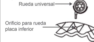
4. Ensamble de rueda: inserte manualmente la rueda universal en el orificio de la placa inferior como muestra el dibujo.
