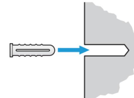
En madera o revestimiento, puede saltarse este paso y atornillar el soporte directamente en la pared.
