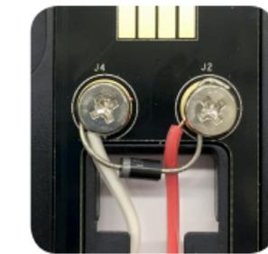
**i** Si su timbre es digital y conecta el diodo incorrectamente, no se producirá ningún daño. Si su timbre no suena, simplemente invierta el diodo.
